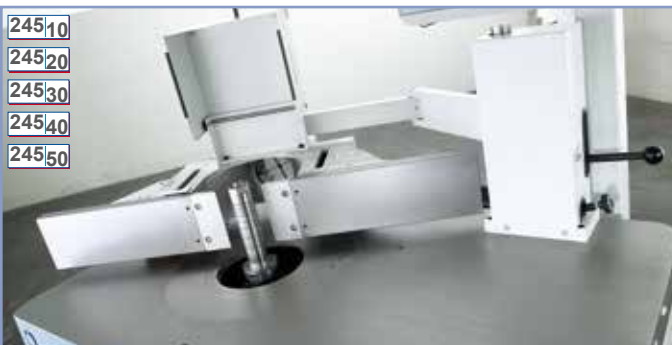
Dispositif hydraulique manuel d'escamotage du guide de toupie, permettant en toute sécurité la levée et l'escamotage du guide Réf.Art. 4349
