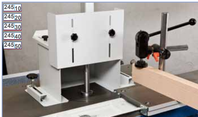
Capot de protection 1641 Réf.Art. 2235 pour outils à tenonner et rainurer jusqu'à 350 mm de diamètre maxi, en tôle d'acier robuste, couvercle de protection réglable, sortie pour aspiration Ø 120 mm
